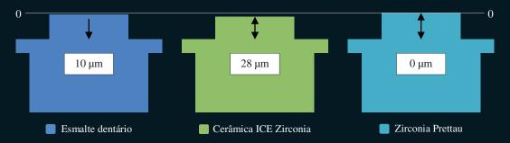
Representação esquemática do efeito abrasivo das várias amostras no corpo de atrito, após 3.024 milhões de ciclos de contato.
